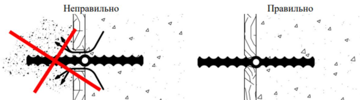
Нельзя устанавливать шпонку в скальную породу, если место соединения скальной породы и гидрошпонки не уплотнено. Для достижения хорошей гидроизоляции нужно проштробить скалу, а затем уплотнить шпонку цементным раствором.
